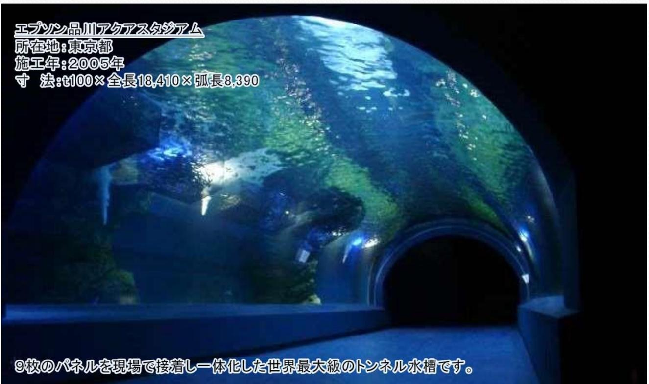
9枚のパネルを現場で接着し一体化した世界最大級のトンネル水槽です。
